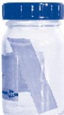
Hladina kapaliny se nesmí během této operace pohybovat. Vývojka nesmí v žádném případě nerovnoměrně zasahovat nanesené skvrny nebo je omývat. Působením kapilárního jevu stoupá vývojka vrstvou nahoru a způsobí separaci látek.
