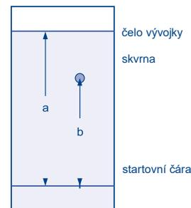
Aby byly zajištěny dobře reprodukovatelné hodnoty  $R_f$ , je však potřebné pečlivě nasycení atmosféry v komoře a udržování ostatních parametrů, jako je například složení vývojky, teplota, atd., na konstantní úrovni.
