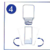
4 Přidávání GH-2 po kapkách, dokud se nezmění barva
